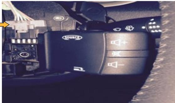
Retire este conector original e conecte o conector da interface neste lugar, o fio azul precisa estar virado para o lado do passageiro conforme a foto 2.
